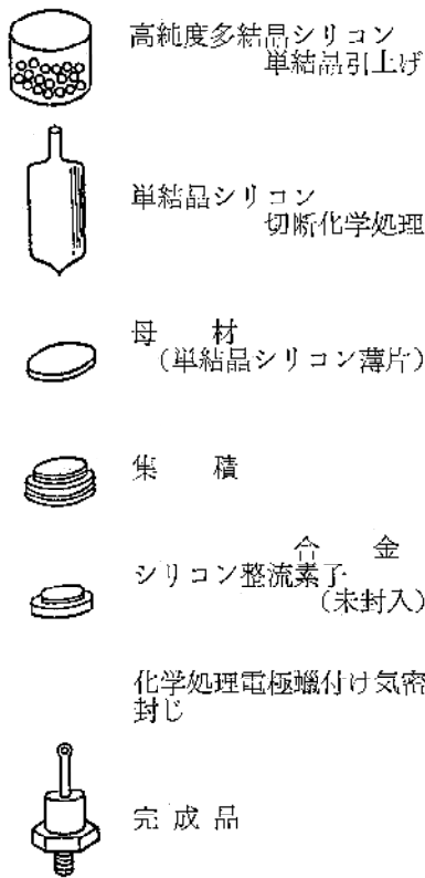
第5図 シリコン整流素子の製造工程
