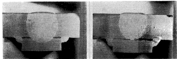
写真9 電流 350A 電圧 35V インサート 0本 ルート間隔 21.5 mm
