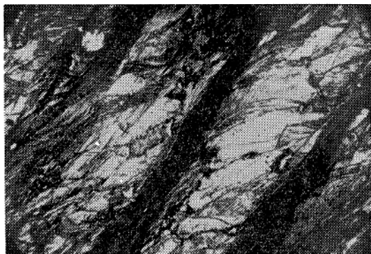
図9 切りくず内部の断熱すべり
