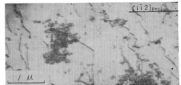
写真15 Dislocation patch (超音波疲労) 16)
