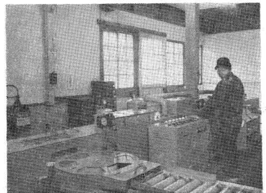
写真5 超音波洗浄機
