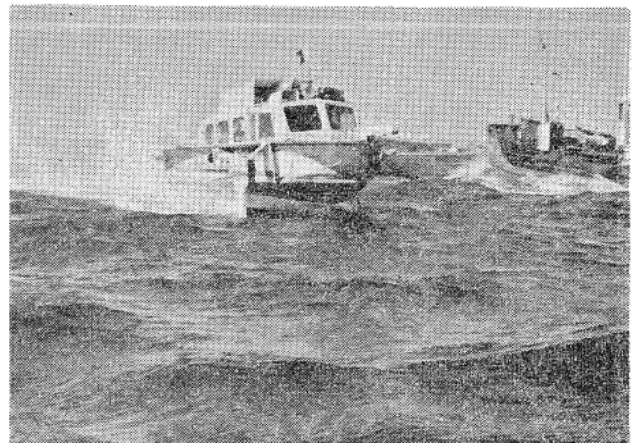
写真1 海上試験中の MH-3 全没形水中翼船
