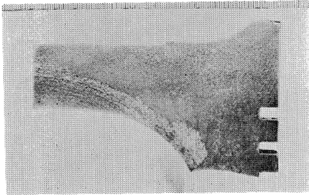
図7 共晶 Al-Si 合金ピストンにおける初晶の偏析
