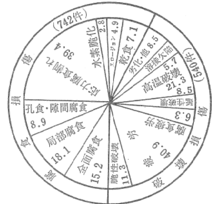
図1 化学装置における損傷解析例
