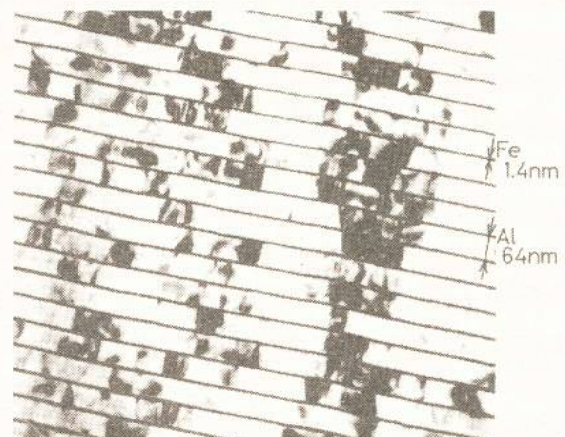
図1 気相成長法で得られたAl-Fe合金の微細組織
