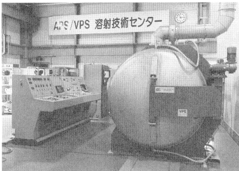
写真2 国内専業メーカーとして初めて導入した、最先端の実用型減圧プラズマ溶射設備（写真正面のチャンパー内にて溶射）
