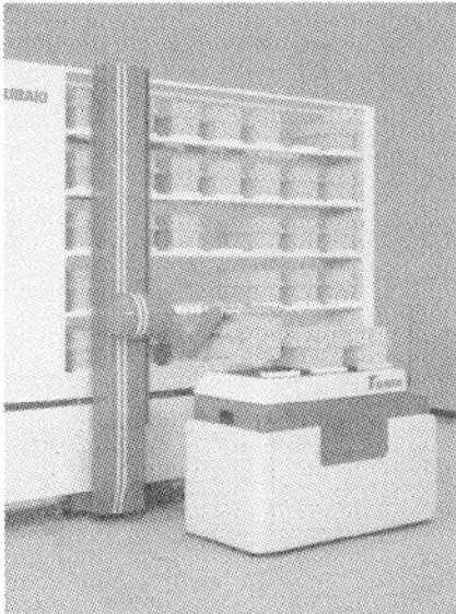
図3 WIP (Work In Process) ステーションから ICボックスを受け取るSGV
