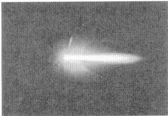
図2 減圧 Ar 雰囲気中での溶射中のプラズマジェット
