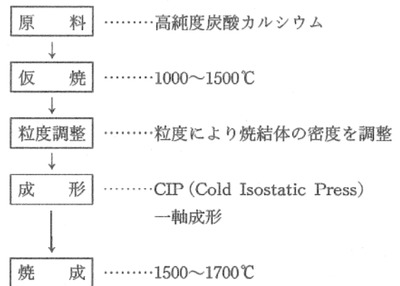
図4 カルシア成形体の製造工程
