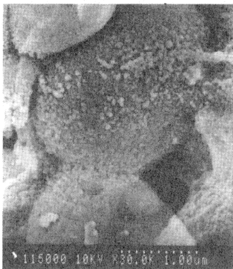
図5 表面処理した硫化カルシウム蛍光体のSEM写真とEDXによる分析
