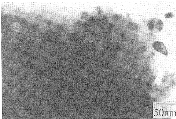
図2 72ksのMG後、結晶化および窒化処理を施した試料のTEM写真
