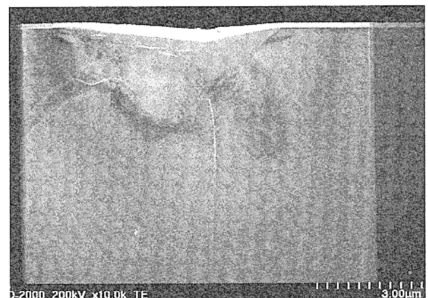
図1 シリコン単結晶のインデンテーション下の転位網観察例
