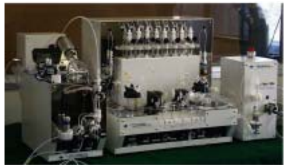
図2: ^{18}\text{F} FDG標識合成装置: ホットセル内に設置され、 \text{H}^{18}\text{F} から ^{18}\text{F} FDGを合成する。放射能レベルが高いため、ロボット技術による自動化が必要。
