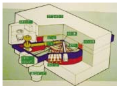
図1 サイクロトロン： 病院内に設置されpositron放出核種の生成に用いられる。
