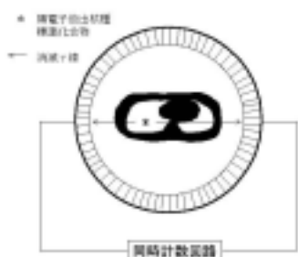
図3：PET測定原理：散乱線や偶発同時計数などのノイズ除去のため、同時計数回路には時間窓が設定されている。飛行時間差情報を加えることにより、位置情報の精度向上が期待されている。
