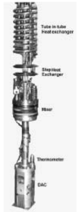
図2 希釈冷凍機に取り付けたDAC
