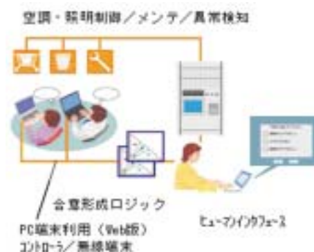
図6 居住者参加型環境制御方式基本構成
