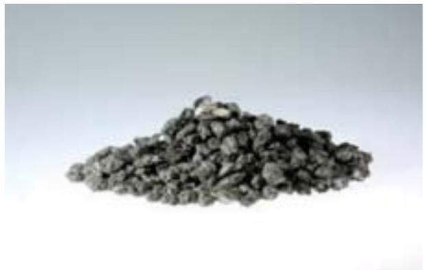
図4. スポンジチタン(整粒後)
