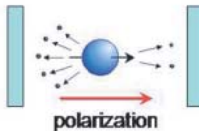
図4 スピンの向きに対して \gamma 線は非等方的に放出される。 \gamma 線を左右に置いた検出器で測定して計数のアンバランスさを求める。
