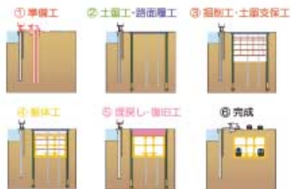
図7 開削工法施工手順
