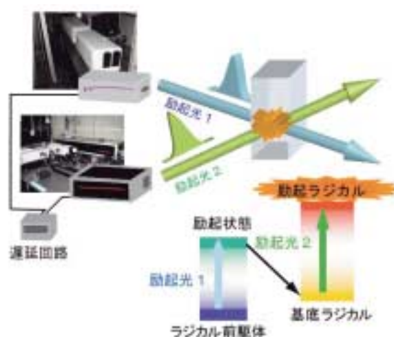
図2. 2波長2レーザーによるラジカルの励起状態の形成過程。
