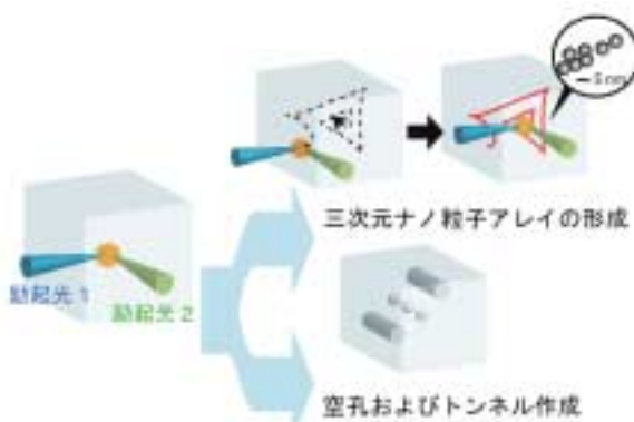
図1. 2つの異なる波長のレーザー(励起光1および2)を用いた三次元加工。
