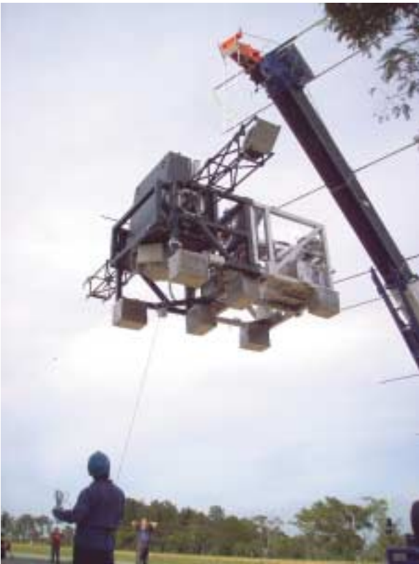
図3 . 宇宙遠赤外線干渉計 F I T E。 ブラジル気球フライト基地内で試験中の様子。
