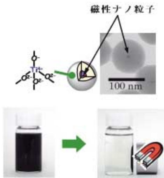
図6. 磁性ナノ粒子を内包したシングルサイト光触媒の調製.
