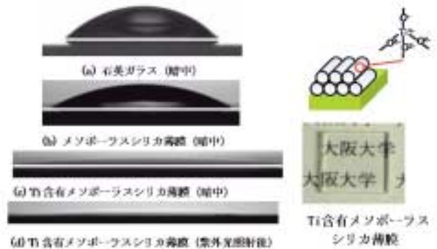
図5. Ti含有メソポーラスシリカ薄膜(透明)の写真と紫外光照射前後の水の接触角.
