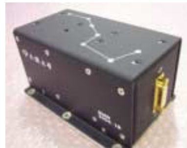
図5. VHF 波帯広帯域波形測定装置(雷センサ)
