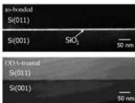
図 1. as-bonded (上)および ODA-treated (下) サンプルの断面 TEM 像.
