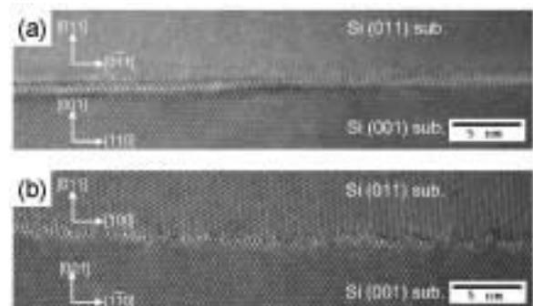
図6 . ODA-treated サンプルにおける接合界面付近の断面TEM 像．観察方向は(a)  $[100]_{Si(011)}$ 、(b)  $[0\bar{1}1]_{Si(011)}$ ．
