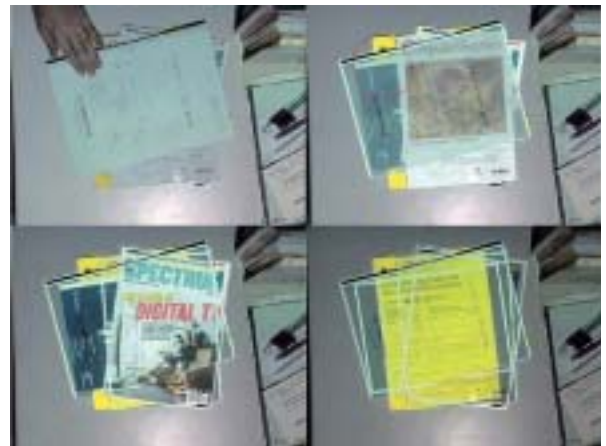
図4 触れは仮想的に透明化する文書による机上書類探索支援： (左上)書類に触れる、(右上)システムが接触を検出、 (左下)上層書類から順番に透明化、(右下)最下層書類を表示
