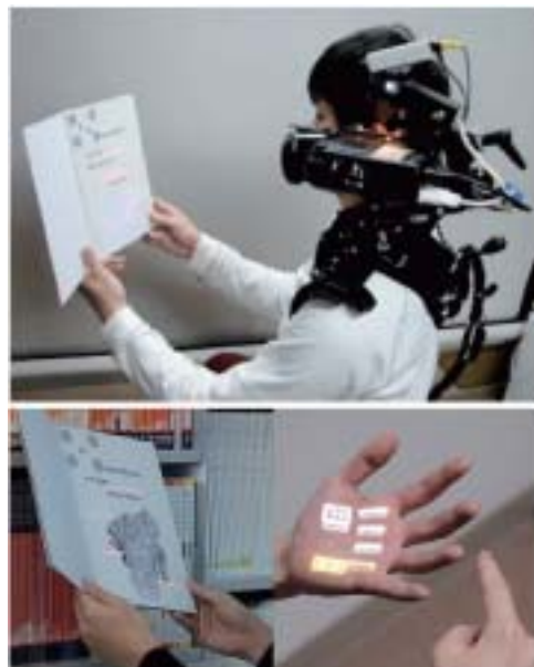
図5 ユビキタスプロジェクト： (上)試作したウェアラブルプロジェクションシステム、 (左下)印刷物へのアノテーション、(右下)掌リモコン
