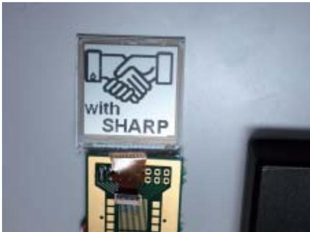
図1 メモリ内蔵液晶ディスプレイ表示例
