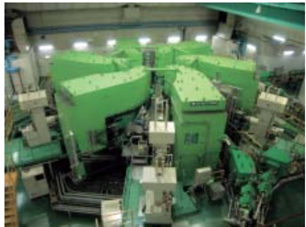
図1：大阪大学核物理研究センターのリングサイクロトロン加速器。高分解能実験を実現するビームを加速する。
