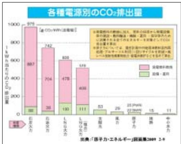
図 1 各種電源別の CO<sub>2</sub> 排出量比較
