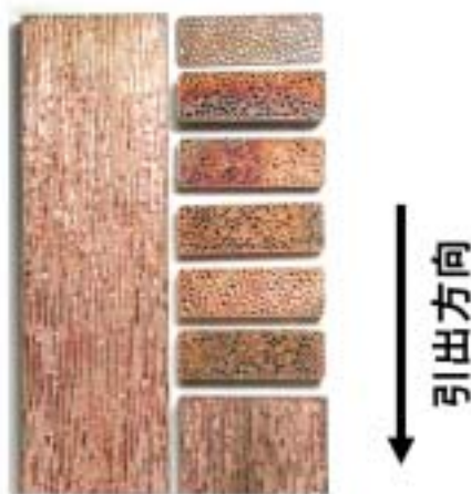
図2 連続鋳造法で作製されたロータス銅。 作製条件：水素ガス雰囲気圧力 1.0MPa、 引出速度 10 mm・min -1 出典：日本金属学会発行「まてりあ」Vol.47 No.4
