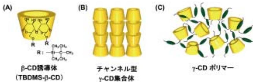
図2 . 油中のPCB吸着剤として働くシクロデキストリン (CD) 誘導体ならびに集合体の模式図 .
