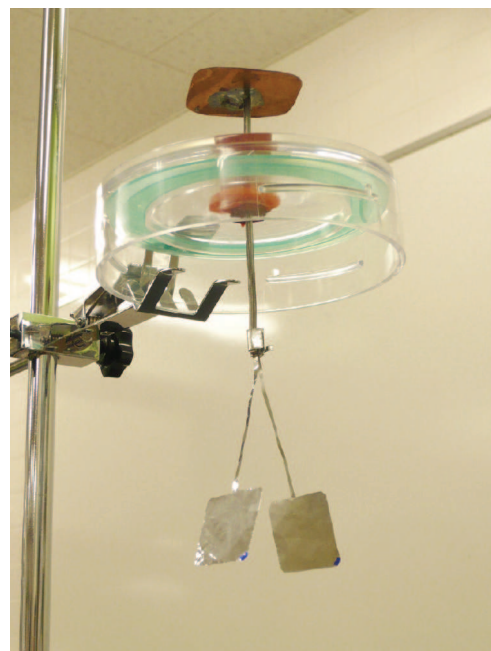
写真1 ジャーを利用して作った検電器 ガラス容器の外で帯電させたところ。
