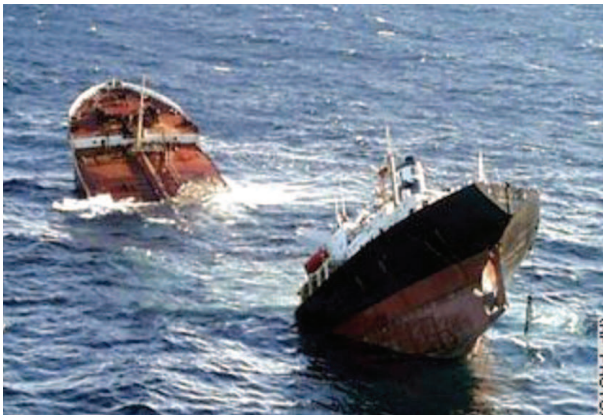
図1 縦曲げ崩壊後の船体（Prestige号，2002）
