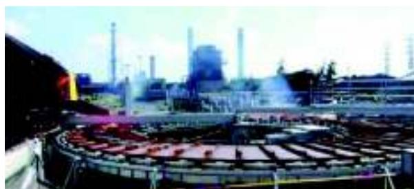
図6 高炉スラグ連続凝固プロセスPACSS ®
