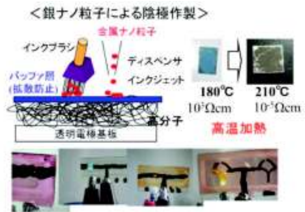
図1 溶液プロセスで銀陰電極作製例と素子からの発光写真
