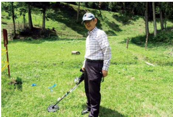
図7 コロンビア共和国メデジン大学構内試験施設にて糸崎研究室開発地雷探知装置の実証試験
