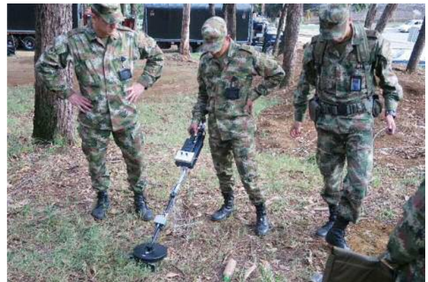
図8 コロンビア共和国陸軍施設での糸崎研究室開発地雷探知装置の実証試験
