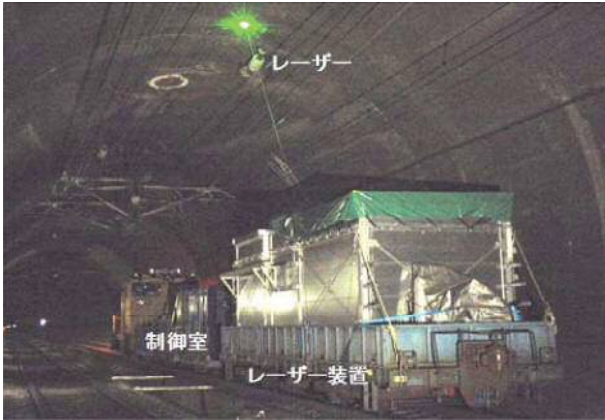
図5 新幹線トンネル内のコンクリート欠陥探傷実験
