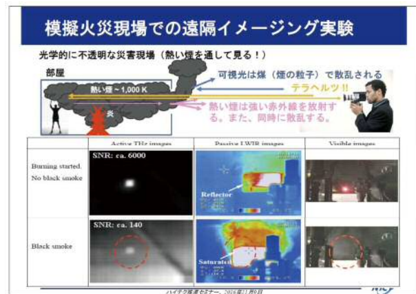
図5 模擬火災現場での遠隔イメージング実験結果
