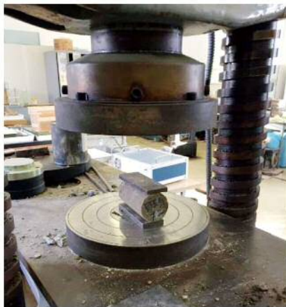
Photo6-1 割裂引張試験
