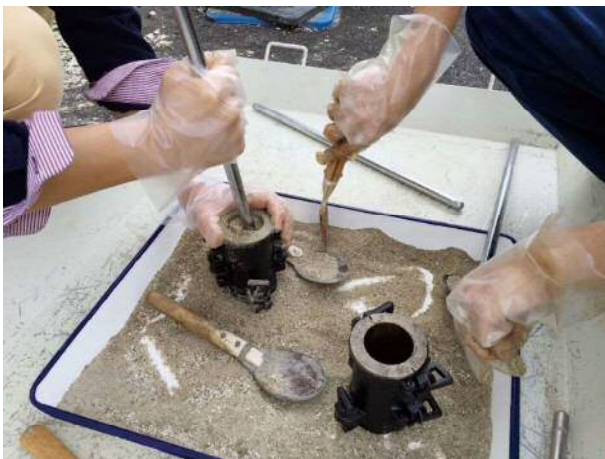
Photo3-1 突き棒による締固め
