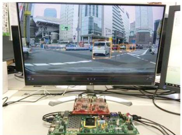
図8: 物体検出システムのハードウェア実装
