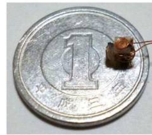
図2: 外部アンテナを用いない超小型無線送信機
