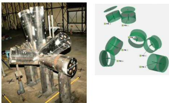
(a) 計測対象格点ブロック (b) データ処理結果 図9 デジタルカメラによる三次元形状計測データ処理
