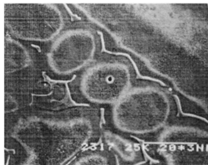
図3 初晶オーステナイトで凝固する溶接金属の孔食 6)
