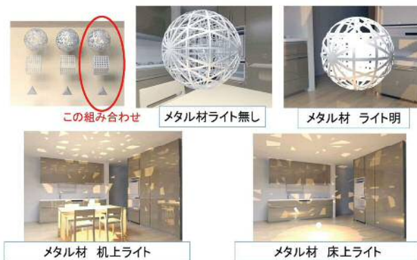
図1 サイバーフィジカル空間の融合によるカスタム照明の検証試験。自分設計したカスタムセードを仮想空間で照明テストをすることができる。
