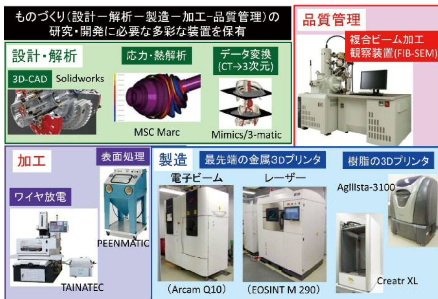
図5 金属3Dプリンタ (a) Q10 (ARCAM社(現GE社)), (b) EOSINT M290 (EOS社)と樹脂3Dプリンタ, (c) AGILISTA-3100 (KEYENCE社), (d) Creatr XL (Leapfrog社)。
