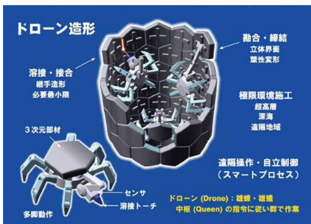
図14 大型造形物の積上施工におけるドローンの将来的な運用 (想定図)
