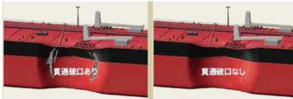
図10 衝突シミュレーション結果のイメージ [7] 一般鋼 (左) と NSafe®-Hull (右)
