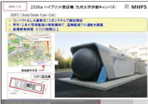
図 11. 250Kw ハイブリッド実証機 (九州大学伊都キャンパス)
