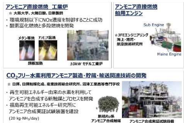
図7. アンモニアの工業炉での利用、アンモニア直接燃焼船用エンジン、CO 2 フリーアンモニア製造用触媒に関する取り組み
