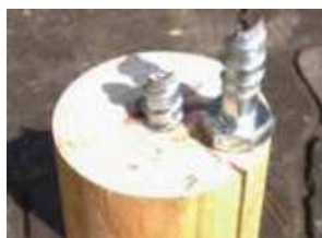
図24 ラグ破断状況
