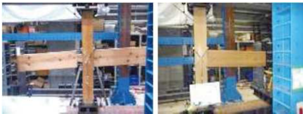
図28 実験の様子(左:十字型、右:T字型)
