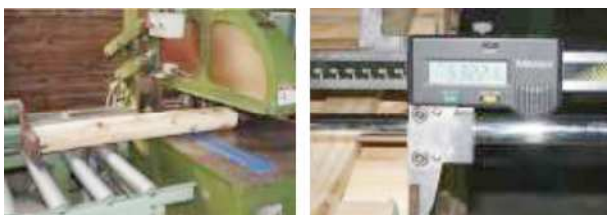
図6 筆者開発の精密切断カッターと超長尺ノギス
