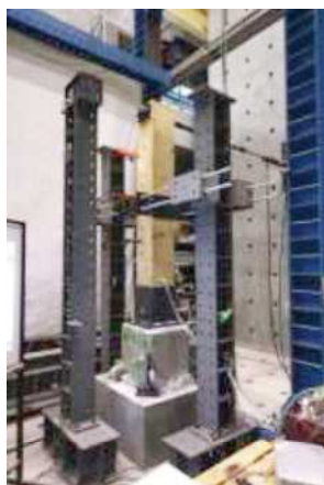
図18 柱脚実験 (250mm角)
