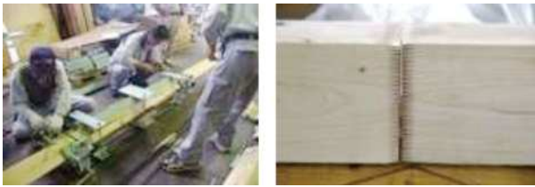
図8 長尺材作業風景と加工面 (5寸角)
