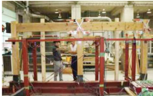
図30 木造ラーメンフレーム実験の様子
