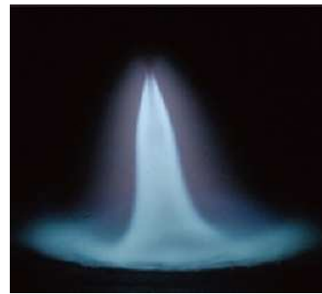
図1 ミグ溶接におけるアークの典型例
